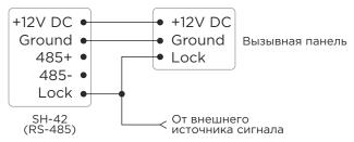
В данном случае модуль соединяется с вызывной панелью тремя проводами: +12 В питания, Земля, и Lock. При таком подключении с абонентских устройств возможно управлять только первым реле. При подаче на вход «Lock» модуля внешнего управляющего сигнала также будет переключаться только первое реле. Для входа «Lock» необходимо использовать внешний сигнал с напряжением постоянного тока от +9 до +12 В
