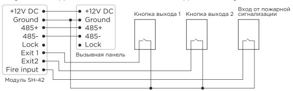
Для подключения кнопки выхода управления первым реле используются контакты **«Выход 1»** и **«Земля»**, а для подключения кнопки выхода управления вторым реле, контакты **«Выход 2»** и **«Земля»**. Контакты **«Вход П.С.»** и **«Земля»** - используются для подключения контактов выхода пожарной сигнализации.
