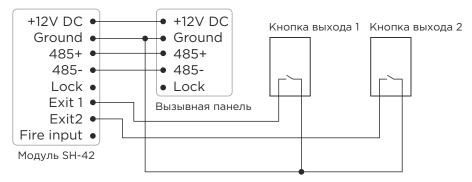
Кнопка выхода для управления первым реле, подключается к контактам **«Выход 1»** и **«Земля»**, а кнопка выхода для управления вторым реле, подключается к контактам **«Выход 2»** и **«Земля»**.
