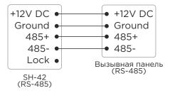
В данном случае вызывная панель соединяется с модулем по четырем проводам: + 12 В питания, Земля, 485+ и 485-. При таком подключении с абонентских устройств возможно управлять двумя реле независимо друг от друга.
